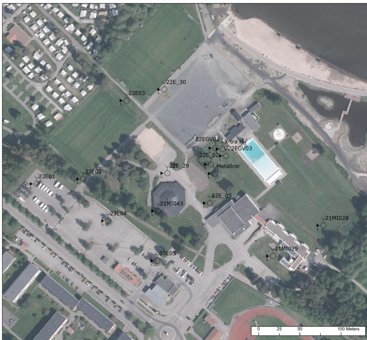
Figur 2. Läge för grundvattenrör som ingått i de kontinuerliga grundvattennivåmätningarna.
